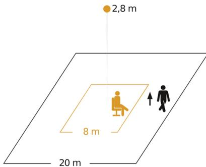
Possibile altezza di montaggio: 2,50 m - 10,00 m
